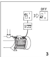
Пользователь должен обеспечить установку внешнего сетевого выключателя (автомата защиты) электропитания насоса. При отключении всех полюсов воздушный зазор между контактами выключателя должен быть не менее 3 мм (для каждого полюса).
