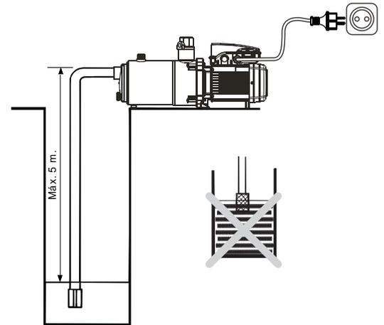
Обратный клапан должен быть установлен на всасывающий трубопровод. Максимальная глубина всасывания 5 метров. Всасывающий трубопровод должен быть залит водой.
