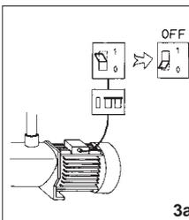
В качестве дополнительной защиты против поражения током, устанавливается дифференциальный выключатель высокой чувствительности (УЗО) с током утечки  $I_n=30\text{mA}$
